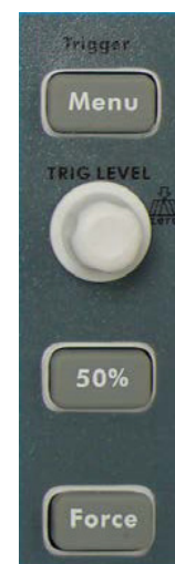
Рисунок 4.13. Поле управления системой запуска
